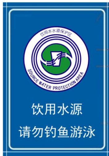
图A. 3. 3 农村供水工程水源保护警示牌版面
